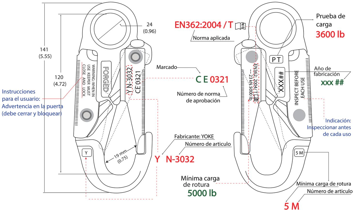
El acero usado, es previamente sometido a un análisis espectrográfico para asegurar, un contenido metalúrgico apropiado. Todos los componentes forjados son sometidos individualmente a una prueba de control Magnaflux para detectar rajaduras.
