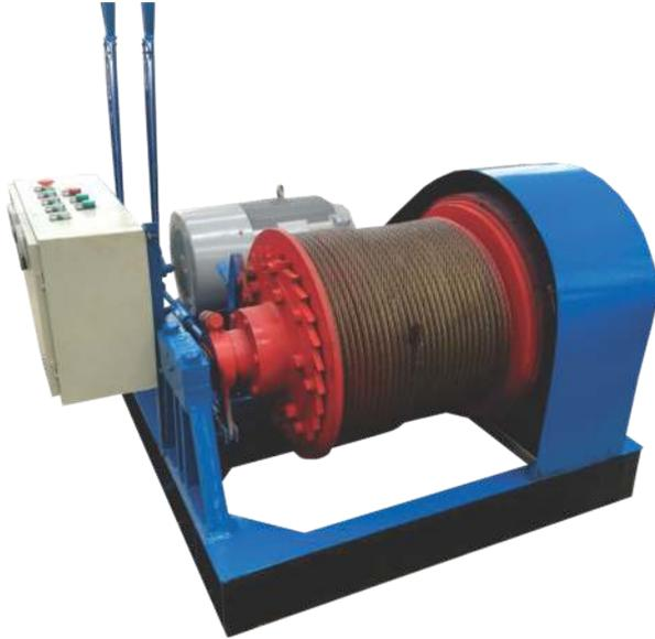
Los Winches Eléctricos modelo WGRFC, son de ALTA VELOCIDAD y CAIDA LIBRE, es decir el freno puede ser liberado por el operario, cuentan con sistema de frenado electrohidráulico, se pueden utilizar tanto en el IZAJE como en ARRASTRE, tienen múltiples aplicaciones y se utilizan en diversas áreas de trabajo, tales como:
