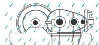
Cuando se utiliza al aire libre, se requiere de un refugio para proteje el equipo de las condiciones ambientales, lluvia, polvo, humedad, calor excesivo, etc.
