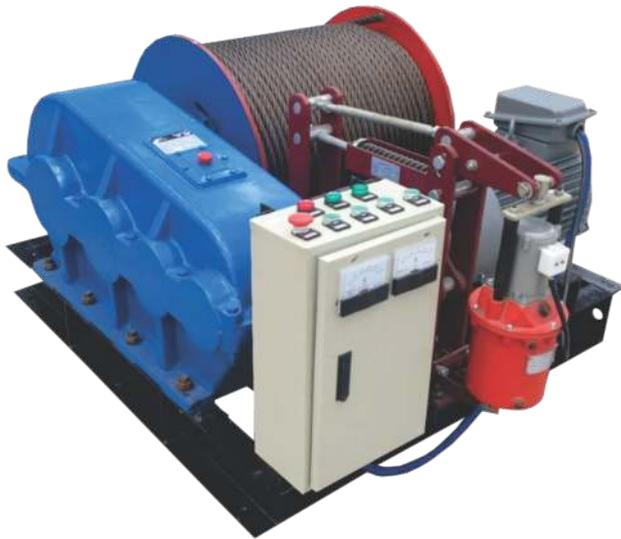
Los Winches Eléctricos modelo WGR, son de ALTA VELOCIDAD, cuentan con sistema de frenado electrohidráulico, se pueden utilizar tanto en el IZAJE como en ARRASTRE, tienen múltiples aplicaciones y se utilizan en diversas áreas de trabajo, tales como:
