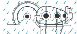
Cuando se utiliza al aire libre, se requiere de un refugio para proteje el equipo de las condiciones ambientales, lluvia, polvo, humedad, calor excesivo, etc.
